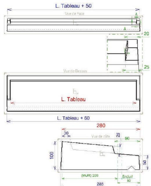
**Appuis fenêtres ou seuils «Traditionnels» IVOIRE PS (Pour construction parasismique) IVOIRE**
