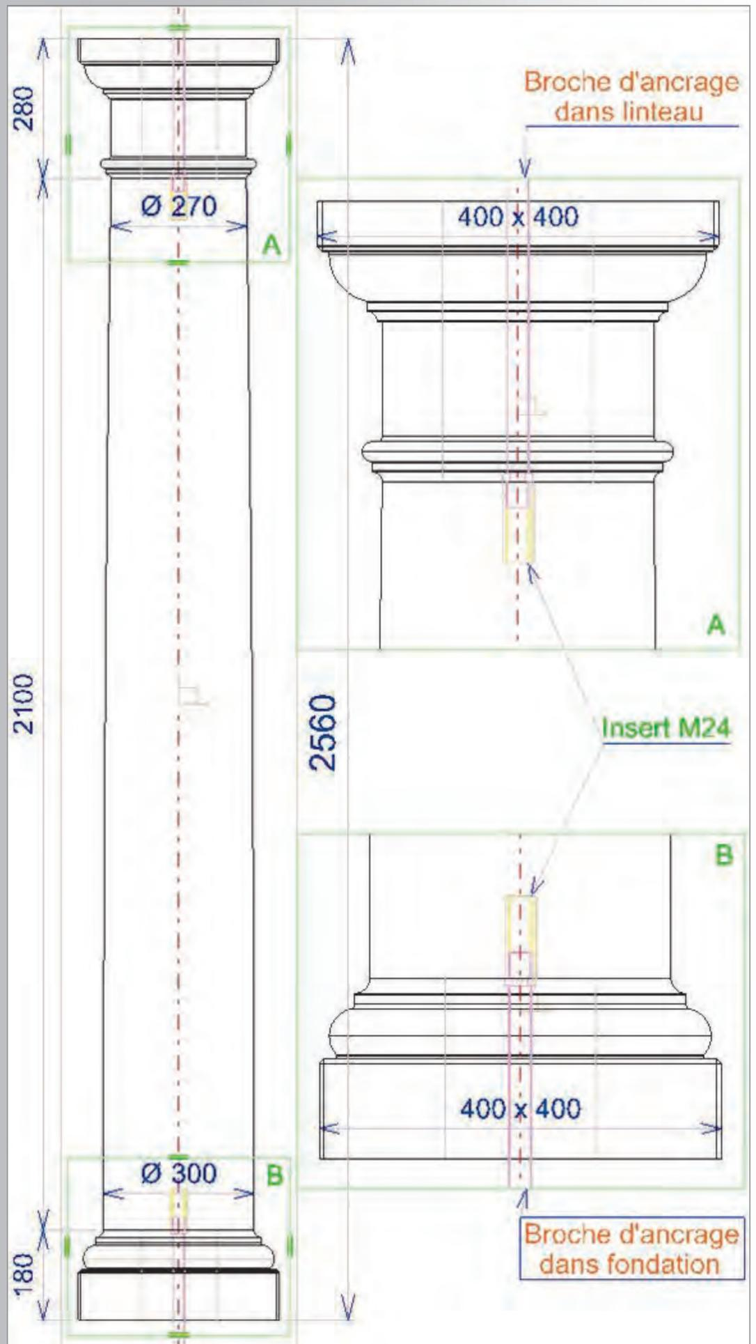
*Colonne pouvant être intégrée dans une étude de béton armé.*
