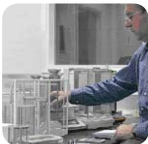
Etalonnage de balance de précision
