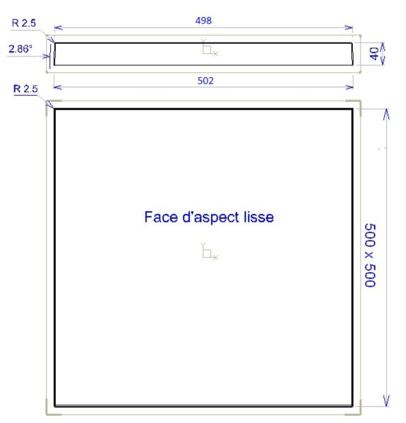
Nb dalles au m2 : 4 (pose sans joint). Poids pièce : 22 Kg. Conditionnement: 40 dalles / palette pour 10m<sup>2</sup> Poids au m2 : 88 Kg.
