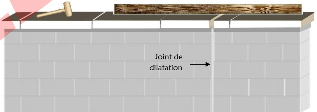
Respecter les joints de dilatation verticaux de vos murs. Il doit y en avoir tous les 5 mètres pour les murs de clôture.
